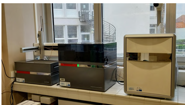
► Parc analytique (analyseur élémentaire, carbonate, spectromètre de masse) installé au LOG à la Station Marine de Wimereux
