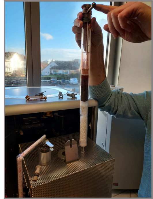
La colonne de combustion de l'analyseur élémentaire
