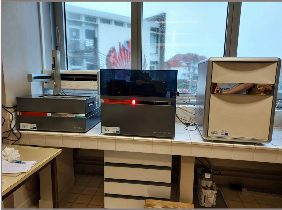
Les trois éléments acquis, de marque Elementar : le spectromètre de masse de ratio isotopique (au centre) couplé avec un analyseur carbonates (à gauche), et un analyseur élémentaire (à droite)
