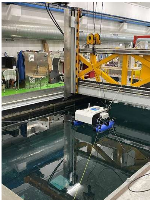
Figure 1 : Caméra hyperspectrale fixée au niveau de la plateforme du Bassin à houle de l'IFREMER
